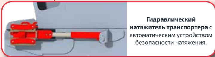
Гидравлический натяжитель транспортера с автоматическим устройством безопасности натяжения.
