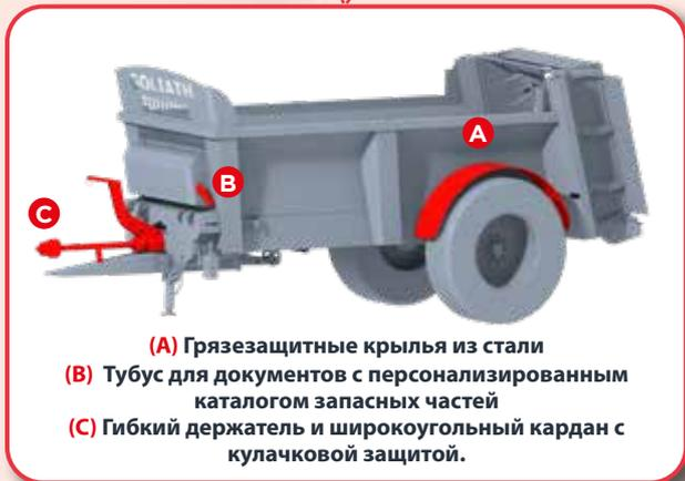
(A) Грязезащитные крылья из стали (B) Тубус для документов с персонализированным каталогом запасных частей (C) Гибкий держатель и широкоугольный кардан с кулачковой защитой.
